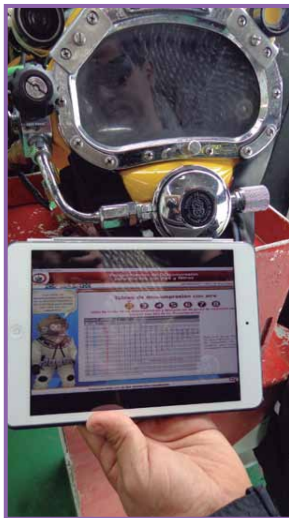
Imagen: Buzos en modalidad semiautónomo (buceo dirigido) apoyándose en el software para la elección de su procedimiento de descompresión. La imagen muestra el casco de buceo Kirby Morgan (de color amarillo) y el umbilical (las mangueras de aire color amarillo y de video color verde) y especialmente el empleo del software en el sitio de trabajo. Por: Buzo S2 Jairo Franco, en la estación de buceo Off Shore de Ecopetrol Coveñas.
